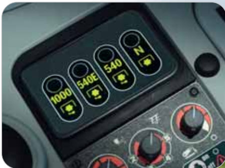
Aftakasschakelaars op het achterspatbord voor extra gemak en veiligheid
