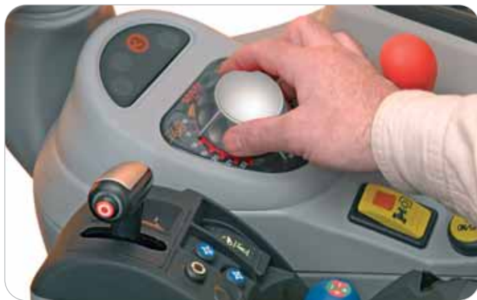
De AutoDrive knop kan op elk moment in de gewenste stand worden gezet om de ideale instellingen voor wisselende omstandigheden en toepassingen te bereiken
