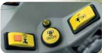
Schakelaars voor aftakstoerental, aftakas inschakelen en 'Auto' activeren zijn praktisch geplaatst en eenvoudig te bedienen
