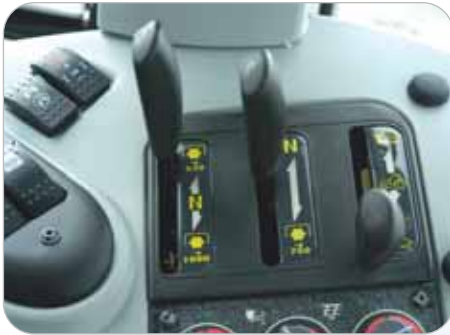
Praktische selectie van aftakstoerental en inschakelen (boven MF 6400; onder, MF 7400)
