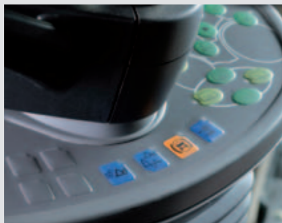
Folietoetsen voor de hydraulische werktuigvergrendeling en de activering van de demping.
