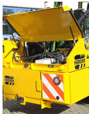
Achterklep met gasveren voor goede toegankelijkheid tot de hydraulische componenten.
