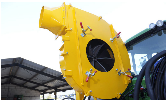
Snelsluiting van de slang op het waaierhuis, waaier met achterover gebogen schoepen.
