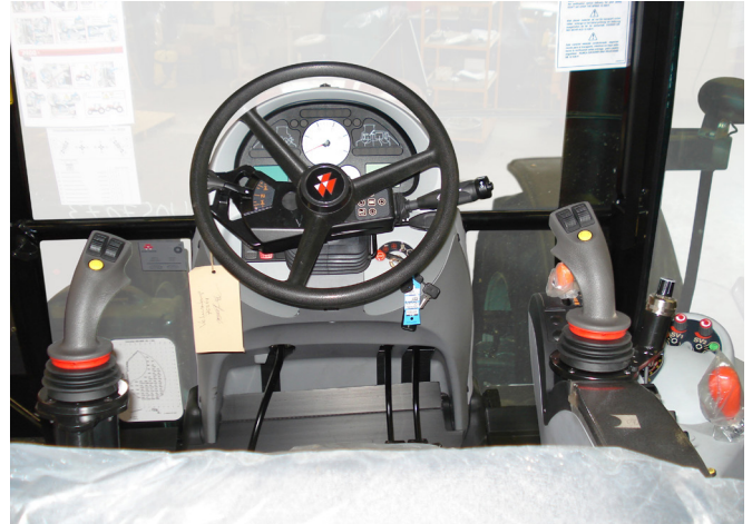
De joystick zorgt voor nauwkeurige bediening van de gieken.
