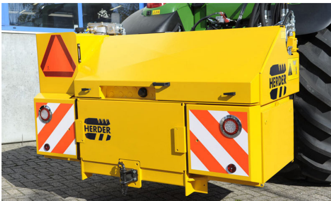
Hydrauliekunit met veiligheidsmarkering en LED verlichting, gedragen in de 3-punt van de tractor.
