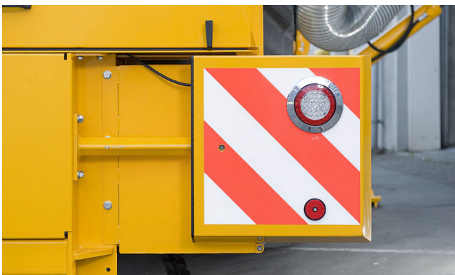
De markeringsborden met LED verlichting zijn uitschuifbaar om bij overschrijding van de breedte norm te kunnen voldoen aan de wegenverkeerswet.
