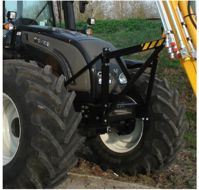
Werktuigdrager aan voorzijde van het aanbouwframe. Hier rust de giek op in transportpositie.
