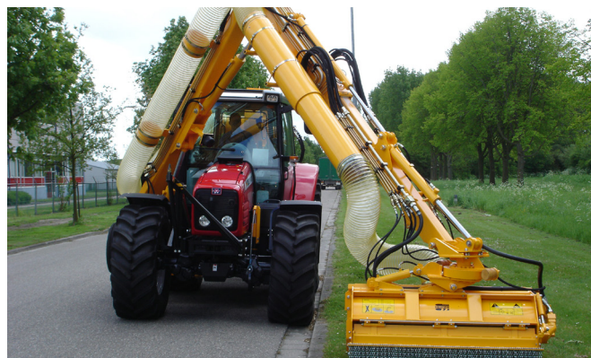
Grenadier MBK513 is uitgevoerd met een draaikolom met 15° extra draaibereik naar links, een schuifgiek en een schuifbuis als alternatief voor de afzuigslang.
