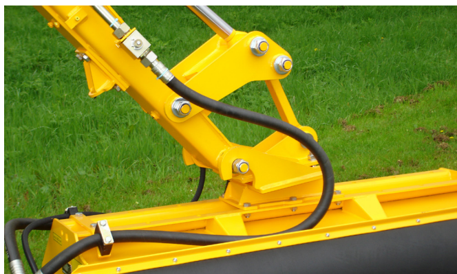
De bakcilinder kan naar wens worden uitgevoerd met een tuimelstuk, die de kiephoek vergroot.
