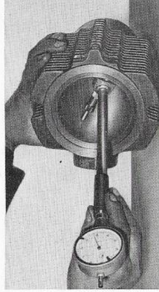
Bild 10 Anwendung der Lehre für Innendurchmesser, um die Abnützung des Zylinders festzustellen.
