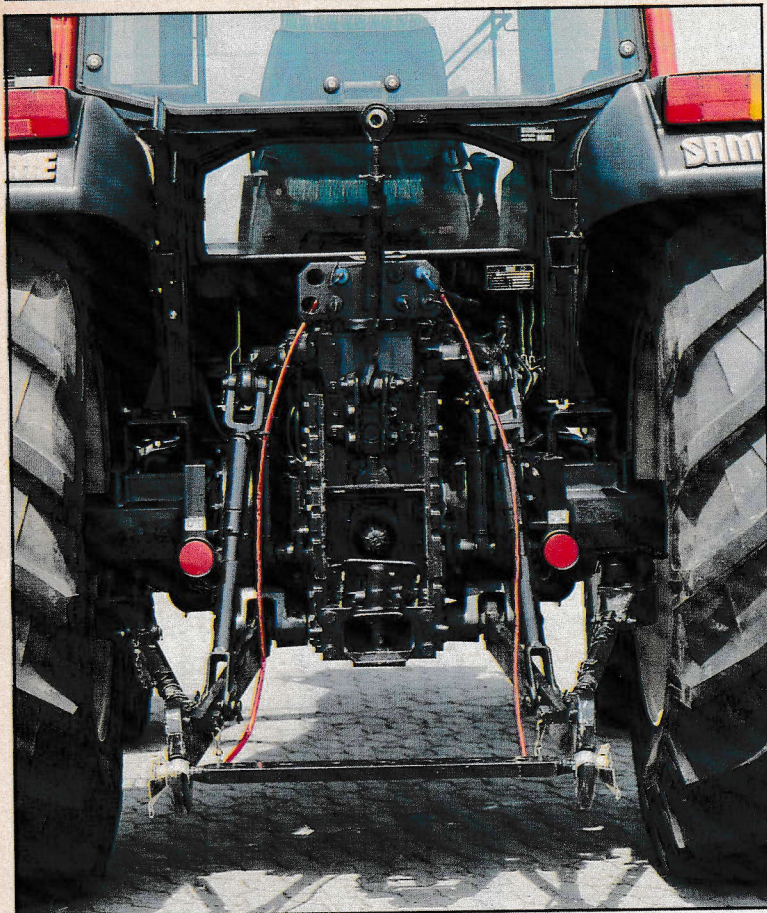
Het hefvermogen van de Antares bedraagt 6.225 kilogram. Dat ligt onder het gemiddelde van vergelijkbare trekkers. Weigert de elektronische bediening van de hef, dan is de knop bovenop de achterbrug te gebruiken. Zo kan de trekker in elk geval van het land af komen. De Antares wordt standaard uitgevoerd met een snelverstelbare trekhaak van Rockinger
