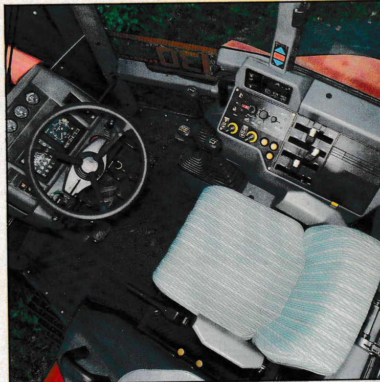
De fraaie cabine is ruim en overzichtelijk. In de console op het rechterspatbord bevinden zich de bedieningsfuncties voor de aftakas, hef, vierwielaandrijving, differentieelsloten en regelventielen. Alle instrumenten zijn goed bereikbaar en duidelijk gecodeerd
